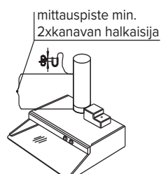
Tehostusilmavirran mittaus
