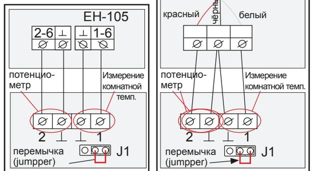
**EH-105:** Функция измерения комнатная температура (клеммы 1) может подключаться в контроллере EH-105 к измерительному каналу 1-6. Потенциометр удалённого доступа (клеммы 2) может подключаться в контроллере EH-105 к измерительному каналу 2-6.
