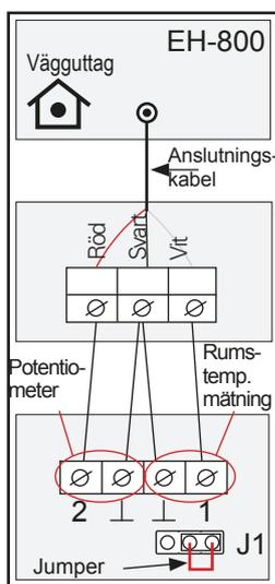
**EH-105:** För kabelanslutningar används kabelgenomföringar avsedda för detta. För fjärrpotentiometer (plint 2) kan anslutas till mätgång 2...6. Mätning av rumstemperatur (plint 1) ansluts till mätgång 1-6 till EH-105.
