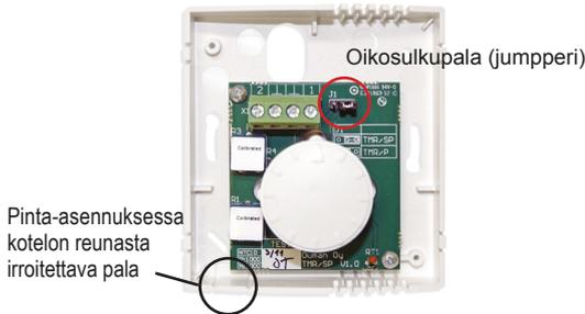
Mittaavana anturina TMR/SP sijoitetaan noin 150 cm:n korkeudelle paikkaan, jossa se mittaa huoneiston keskimääräistä lämpötilaa. Huoneanturia ei saa asentaa auringonpaisteeseen eikä lämmönlähteen lähelle.
